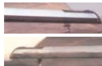
La pollution de la surface de l'aile gauche, par rapport à celle de l'aile droite, provoquait une diminution de portance et une augmentation de traînée à gauche.
