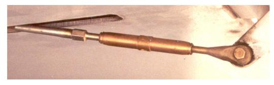
Photographie du dispositif après réglage et immobilisation (éléments d'immobilisation de part et d'autre du tendeur).
